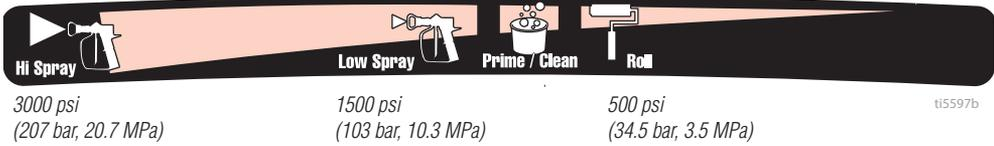
Para seleccionar una función, alinee el símbolo de la perilla de control de presión con el indicador de ajuste del pulverizador.
